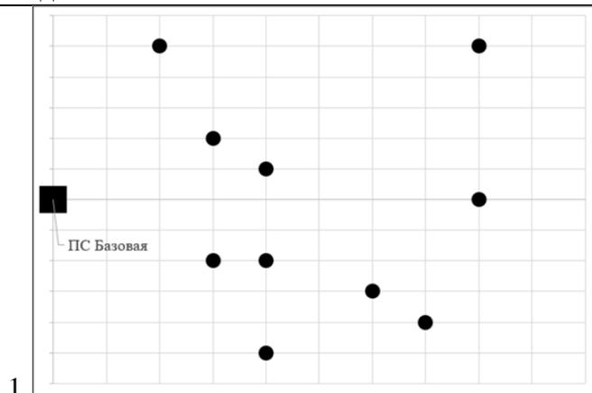
Задано топологическое расположение узлов нагрузки для распределительной сети 10 кВ. Шаг сетки на рисунке по вертикали и по горизонтали 500 м. Узлы нумеруются слева направо, снизу вверх.
