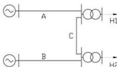
Система передачи электроэнергии состоит из источников энергии, трансформаторов и линий электропередачи А,В,С. Источники электроэнергии и шины считаем абсолютно надежными элементами. Показатели надежности линий и трансформаторов следующие :
