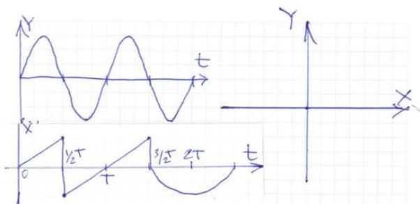
32. На входе вертикального отклонения Y ЭЛО действует синусоидальное напряжение. На входе горизонтального отклонения ЭЛО действует напряжение, представленное в задании. Генератор развертки ЭЛО выключен. Найти изображение на экране ЭЛО.
