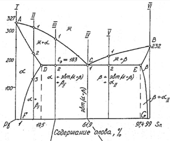
2. Опишите процесс кристаллизации сплава V диаграммы Pb-Sn и постройте кривую охлаждения
