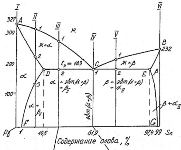
3. Опишите процесс кристаллизации сплава II диаграммы Pb-Sn найти количество твердой и жидкой фаз при температуре 290 градусов Цельсия для этого сплава
