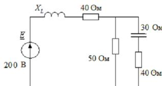
Подобрать  $X_L$  по условию резонанса в цепи. В режиме резонанса найти токи. Построить векторную диаграмму токов и топографическую диаграмму напряжений
