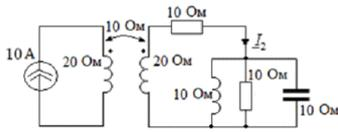
Определить ток  $I_2$ . Построить векторную диаграмму токов и топографическую диаграмму напряжений.
