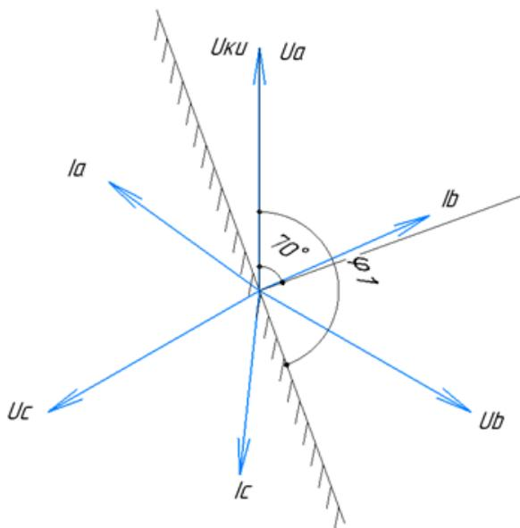
Figure 9 Рисунок 3 - Характеристика срабатывания РНМ
