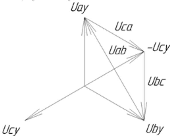
Figure 12 Рисунок 2- Векторная диаграмма напряжений во вторичных обмотках звезды ТН
