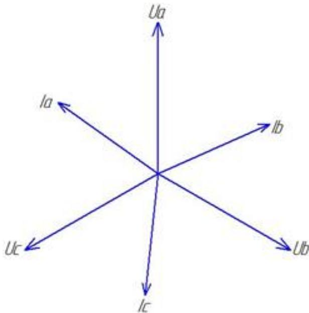
Figure 8 Рисунок 2 - Векторная диаграмма токов и напряжений
