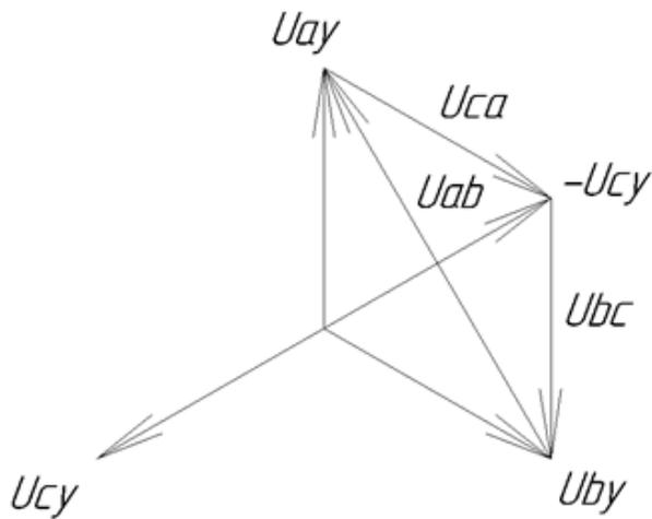
Figure 14 Рисунок 2- Векторная диаграмма напряжений во вторичных обмотках звезды ТН
