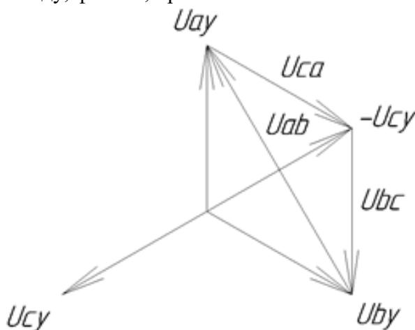
Figure 4 Рисунок 2- Векторная диаграмма напряжений во вторичных обмотках звезды ТН
