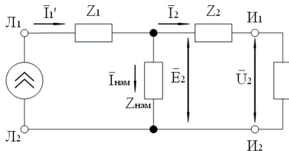
Figure 2 Рисунок 2. Схема замещения трансформатора тока
