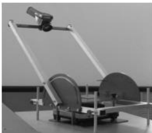
Figure 5 Рис. 5 Тепловизионная съемка при разных углах визирования
