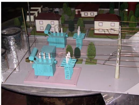
Figure 1 Рис.1. Три группы моделей объектов различного назначения, расположенные на заземленной плоскости
