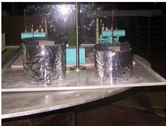
Figure 7 Рис. 7. Модель резервуарного парка
