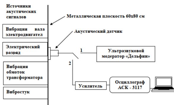
Figure 12 Рис. 1 Схема лабораторного стенда
