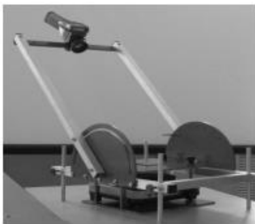
Figure 5 Рис. 5 Тепловизионная съемка при разных углах визирования
