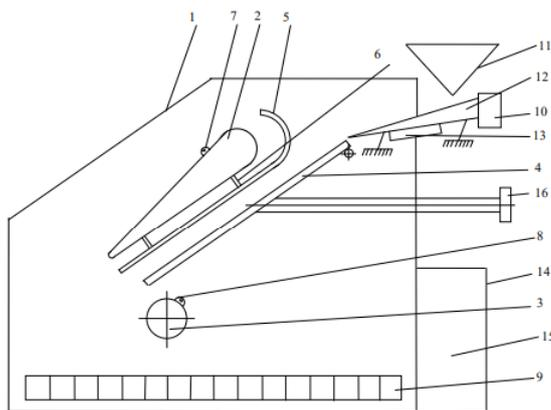
Figure 5 Рис.1 Схема лабораторного пластинчатого электростатического сепаратора
