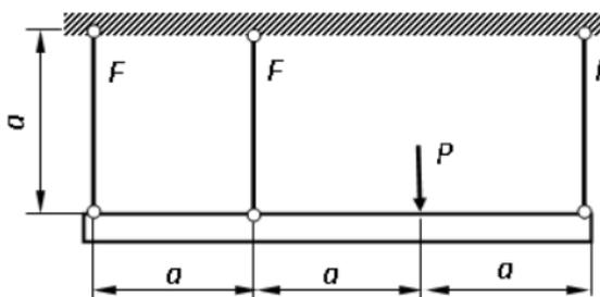
Как изменятся напряжения в стержнях при установившейся ползучести? Параметры, указанные на рисунке, а также  $A$ ,  $n$  считать известными.
