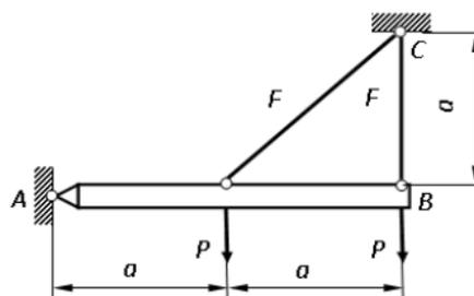
Как изменятся напряжения в стержнях при установившейся ползучести? Параметры, указанные на рисунке, а также  $A$ ,  $n$  считать известными.
