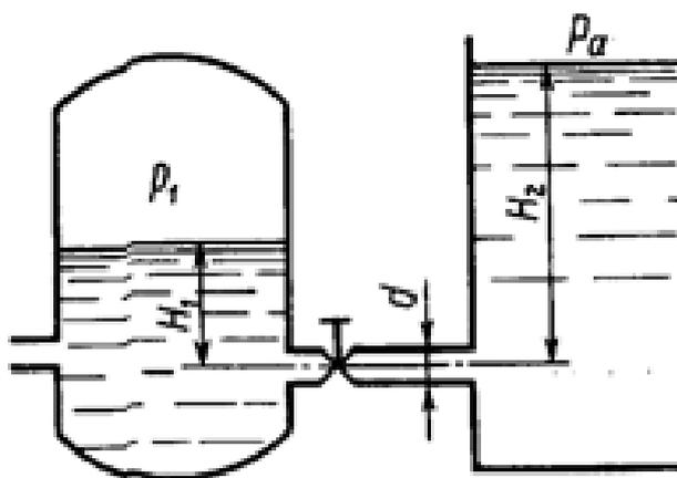
1. Вода перетекает из напорного бака, где избыточное давление воздуха  $p=0,3$  МПа, в открытый резервуар по короткой трубе диаметром  $d=50$  мм, на которой установлен кран. Чему должен быть равен коэффициент сопротивления крана для того, чтобы расход воды составлял  $Q=8,7$  л/с?
