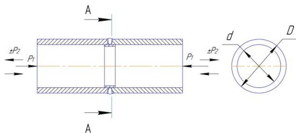
Проверить прочность сварного соединения исходя из допускаемых напряжений.
