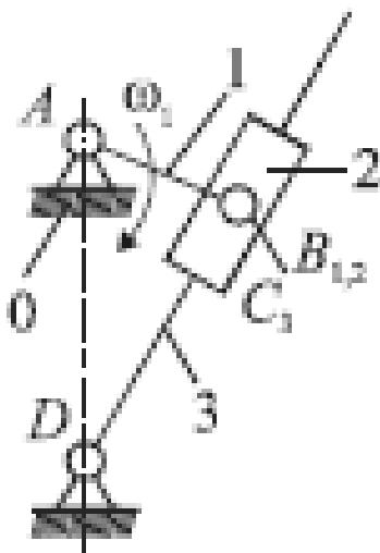
Вопрос 3. Данна схема плоского кулисного механизма, рабочий ход которого осуществляется при повороте кулисы 3 по ходу часовой стрелки. Длина кривошипа 11 = 0,1 м. Коэффициент изменения средней угловой скорости кулисы при холостом и рабочем ходах  $K\omega = 2$ . Определить межосевое расстояние lAD.
