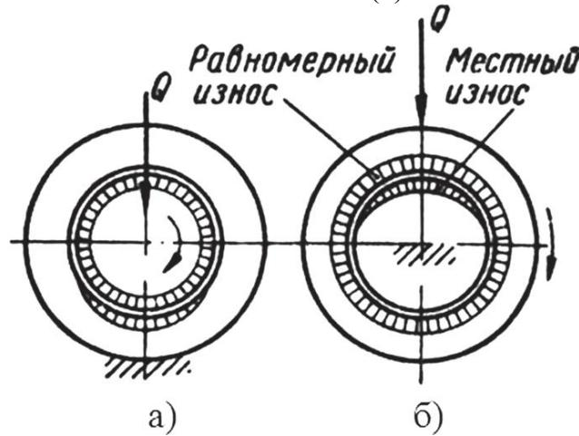
9. Поясните механизм изнашивания деталей во вращательной паре, если вектор нагружающей силы следует за движением вращающегося элемента?
