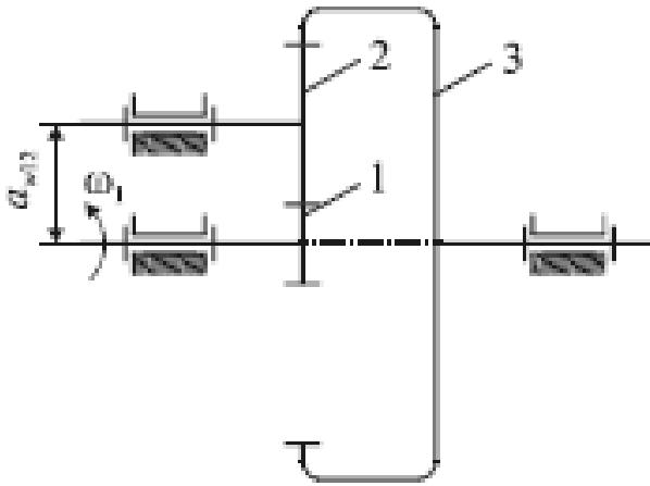
8. Вопрос 1. Структура и кинематика планетарного механизма с тремя центральными колесами (редуктор со свободным водилом).
