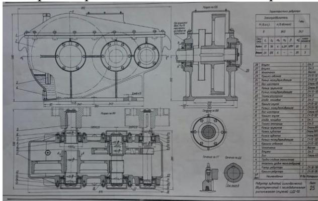
2. Вопрос 1. Опоры валов. Основные функциональные элементы и узлы. Фиксирующая и плавающая опоры. Схемы закрепления валов в опорах.
