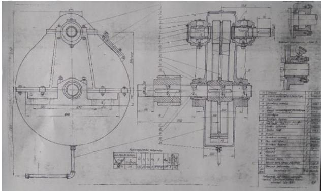
7.Вопрос 1. Опоры валов. Основные функциональные элементы и узлы. Фиксирующая и плавающая опоры. Схемы закрепления валов в опорах.
