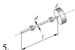
Получить уравнение собственных частот крутильных колебаний вала с закрепленным на конце жестким диском. Момент инерции диска  $J = \rho I_p$ , где  $I_p$  – полярный момент инерции поперечного сечения вала, плотность материала вала –  $\rho$ , модуль сдвига –  $G$ . Найти асимптотическое значение для высших собственных частот.
