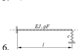
Используя метод начальных параметров, составить уравнение для определения собственных частот изгибных колебаний стержня. Жесткость пружины  $c = \frac{EJ}{l^3}$ , где  $EJ$  – изгибная жесткость сечений стержня,  $l$  – его длина.
