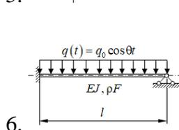
С использованием метода начальных параметров получить установившееся решение задачи о вынужденных поперечных колебаниях стержня, находящегося под действием распределенной нагрузки интенсивностью  $q(t) = q_0 \cos \theta t$ .
