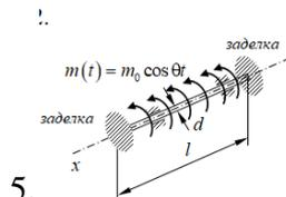
Получить установившееся решение задачи о вынужденных крутильных колебаниях стержня с поперечным сечением диаметра  $d$  и несущего на конце диск с моментом инерции  $J = \rho l I_p$  – где  $I_p$  – полярный момент инерции поперечного сечения вала,  $\rho$  – плотность,  $G$  – модуль сдвига. На стержень действует распределенный момент интенсивностью  $m(t) = m_0 \cos \theta t$
