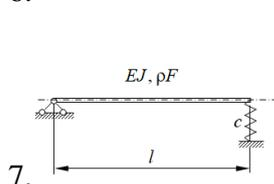
Используя метод начальных параметров составить уравнение для определения собственных частот изгибных колебаний стержня, левый конец которого шарнирно оперт, а правый опирается на пружину. Принять жесткость пружины равной  $c = \frac{EJ}{l^3}$
