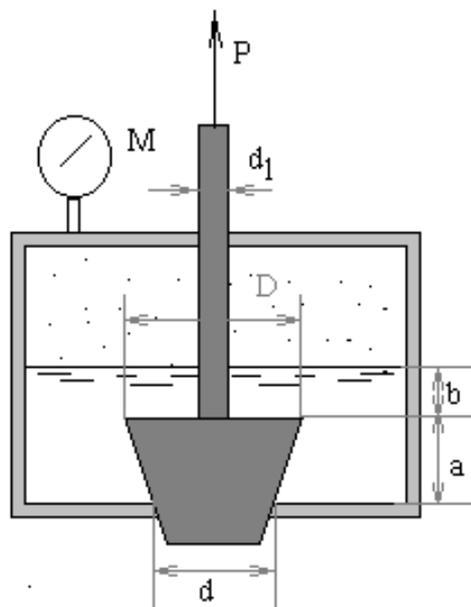
2. Отверстие в дне сосуда, содержащего масло относительной плотностью  $d = 0,83$ , закрыто конической пробкой с размерами  $D = 100 \text{ мм}$ ,  $d = 50 \text{ мм}$  и  $a = 100 \text{ мм}$ , укрепленной на штоке диаметром  $d_1 = 25 \text{ мм}$ . Уровень масла расположен выше пробки на
