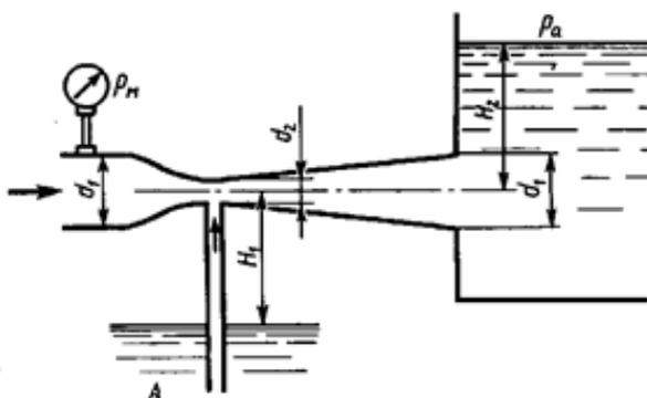
Определить минимальное давление  $p_m$ , измеряемое манометром перед сужением трубы, при котором будет происходить подсасывание воды из резервуара  $A$  в узком сечении трубы. Размеры:  $d_1=60$  мм;  $d_2=20$  мм;  $H_1=6$  м;  $H_2=1$  м. Принять коэффициенты сопротивления: сопла  $\zeta=0,08$ , диффузора  $\zeta_{\text{диф}}=0,30$ .
