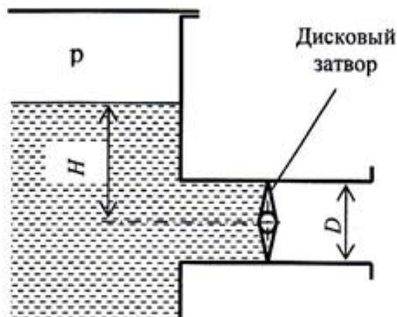
1. Закрытый резервуар с жидкостью плотностью  $900 \text{ кг/м}^3$  имеет выпускную трубу диаметром  $D = 0,5 \text{ м}$ , перекрытую дисковым затвором. Избыточное давление в резервуаре равно  $p = 8 \text{ кПа}$ , уровень жидкости находится над горизонтальной плоскостью, проходящей через ось затвора, на высоте  $H = 0,65 \text{ м}$ . Найти силу давления  $R$  на затвор и момент  $M$  этой силы относительно оси поворота затвора.
