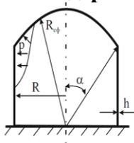
Оболочка вращения, состоящая из сферической и цилиндрической частей, нагруженная внутренним давлением. Толщина оболочки постоянна.
