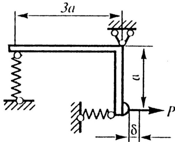
2. Из условия прочности определить допускаемое значение силы  $[P]$ .
