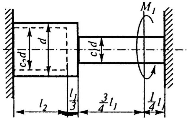
1. Раскрыть статическую неопределимость, построить эпюру крутящих моментов. Из расчета на прочность определить допускаемое значение диаметра сечения  $d$ .
