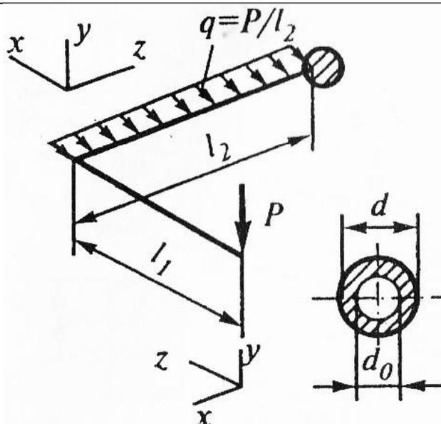
1. Построить эпюры изгибающих и крутящих моментов. По критерию прочности Сен-Венана определить параметр внешней нагрузки.
