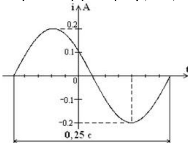
**Задача 2.** Определить параметры последовательной схемы замещения приемника, если  $f = 50$  Гц. Изобразить его схему замещения. Построить векторную диаграмму (1,5 балла)
