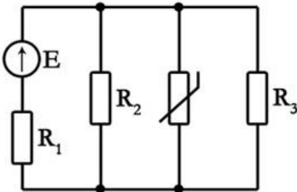
**Задача 3.** Решая задачу методом эквивалентного активного двухполюсника, определить ток в резисторе  $R_2$ .  $E = 60$  В,  $R_1 = 8$  Ом,  $R_2 = 12$  Ом,  $R_3 = 8$  Ом,  $R_4 = 6$  Ом,  $R_5 = 2$  Ом (2 балла)
