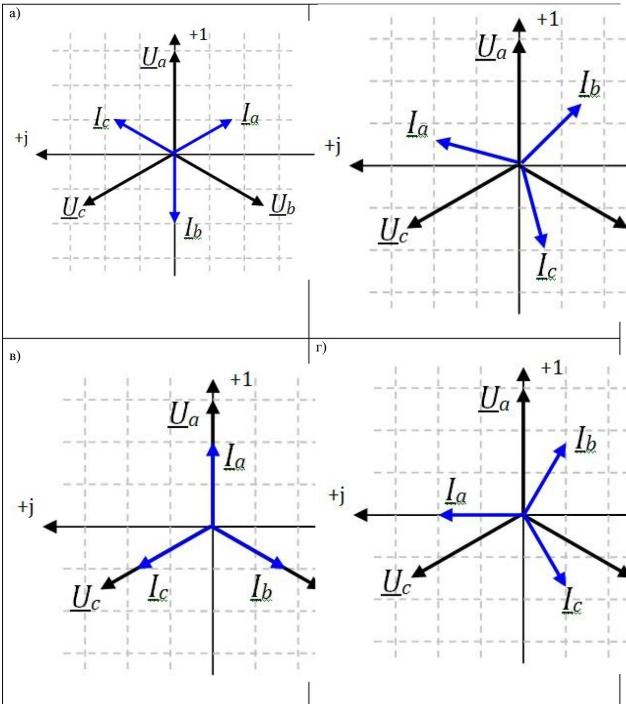
7. К трехфазной сети с номинальным напряжением 400 В подключаются три одинаковых однофазных резистивных приемника. Номинальное напряжение каждого приемника 400 В. Как необходимо включить приемники в сеть для их нормальной работы?
