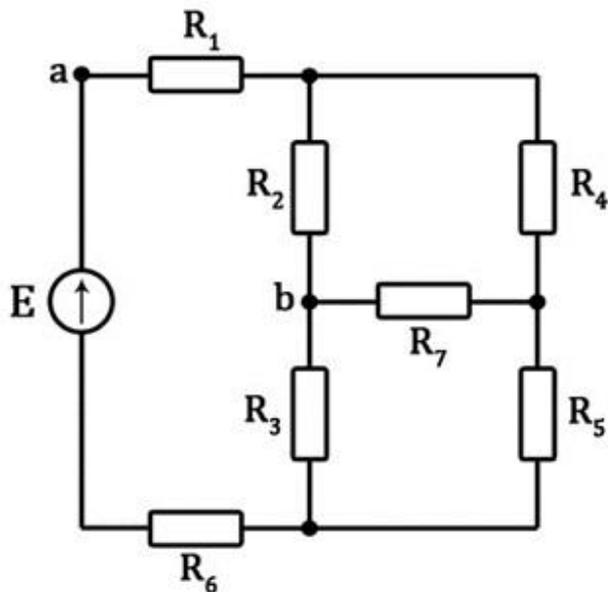
**Задача 18.** Используя метод эквивалентного активного двухполюсника, определить параметры его последовательной схемы замещения ( $E_{\text{эк}}$  и  $R_{\text{эк}}$ ) относительно зажимов  $a$  и  $b$  в схеме.  $E = (16V)$  В. Значения сопротивлений:  $R_1 = 3 \text{ Ом}$ ,  $R_2 = 2 \text{ Ом}$ ,  $R_3 = 0$ ,  $R_4 = 2 \text{ Ом}$ ,  $R_5 = 4 \text{ Ом}$ .
