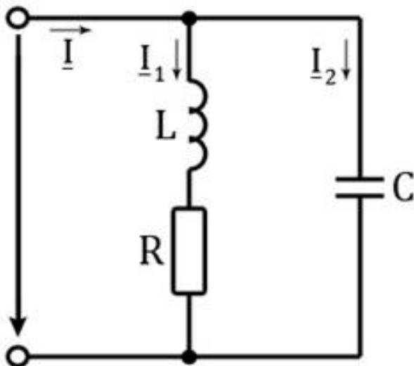
2. Определить показание вольтметра. Построить векторную диаграмму.  $U = 10 \text{ В}$ ,  $R_1 = R_2 = 10 \text{ Ом}$ ,  $X_L = X_C = 10 \text{ Ом}$ .
