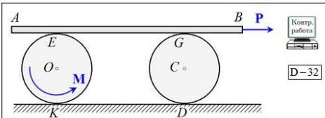
Определить ускорение центра масс рейки, которая опирается на два цилиндра. Цилиндры геометрически идентичны, но имеют различные массы, качение происходит без проскальзывания. К левому цилиндру радиуса  $r$  приложена пара сил с моментом  $M$ . Движение рейки осуществляется без скольжения, к ней приложена горизонтальная сила  $P$ . Массы тел  $m_i$ .
