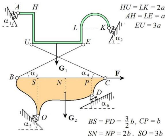
Figure 1 Задача 1. Составная конструкция. Для решения требуется компьютер.
