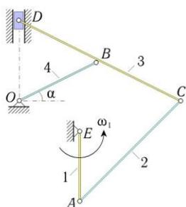
В стержневом механизме кривошип  $AE$ , длины  $l_1$ , вращается с известной угловой скоростью  $\omega_1$ . Известно, что  $BO = BC = BD = l$ . В положении, указанном на рисунке, определить угловые скорости всех звеньев и скорость точки  $D$ .
