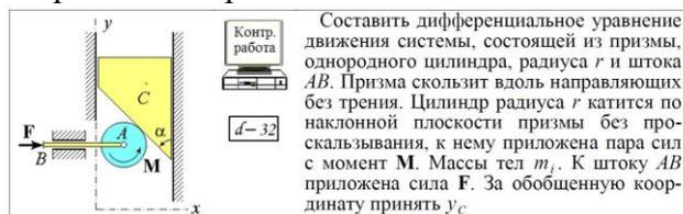
Составить дифференциальное уравнение движения системы, состоящей из призмы, однородного цилиндра, радиуса  $r$  и штока  $AB$ . Призма скользит вдоль направляющих без трения. Цилиндр радиуса  $r$  катится по наклонной плоскости призмы без проскальзывания, к нему приложена пара сил с момент  $M$ . Массы тел  $m_j$ . К штоку  $AB$  приложена сила  $F$ . За обобщенную координату принять  $y_C$ **Контрольные вопросы/задания:**
