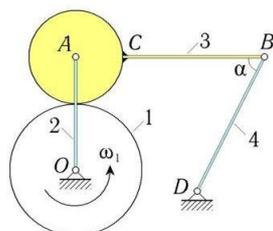
В механизме Уатта шестерня 1, радиуса  $r_1$ , вращается с известной угловой скоростью  $\omega_1$ . Малая шестерня, радиуса  $r_2$ , жестко связанная со стержнем  $BC$ , длины  $l$ . Известно, что  $BD = r_4$ . Найти угловые скорости всех звеньев, полагая, что в этот момент времени угол  $BAO$  прямой, а угол  $\alpha$  равен  $60^\circ$ .
