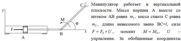
принять угол  $\varphi$  и координату  $x$  поршня.
