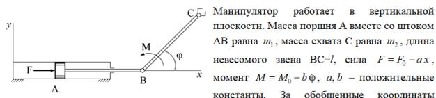
принять угол  $\phi$  и координату  $x$  поршня.
