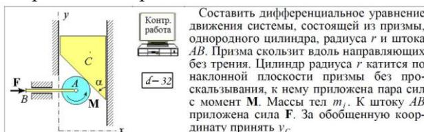
Составить дифференциальное уравнение движения системы, состоящей из призмы, однородного цилиндра, радиуса  $r$  и штока  $AB$ . Призма скользит вдоль направляющих без трения. Цилиндр радиуса  $r$  катится по наклонной плоскости призмы без проскальзывания, к нему приложена пара сил с момент  $M$ . Массы тел  $m_j$ . К штоку  $AB$  приложена сила  $F$ . За обобщенную координату принять  $y_C$
