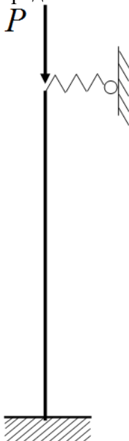
Figure 2 Постройте зависимость критической силы от жесткости пружины. Сравните результаты расчета предельных случаев с решениями Эйлера.
